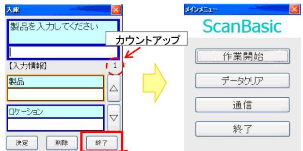
⑥ 作業データをPCに取り込みます。まず、PC側のScan Basicのソフトを立ち上げます。同時にBT-W70/W80をクレードルに置いて通信ボタンをクリックするとPCとBT-W70で通信を開始します。
